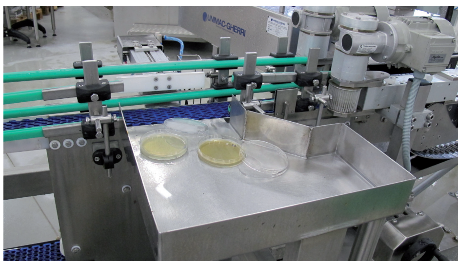
Obr. 1. Príklad umiestnenia Petriho misiek s rôznymi živnými médiami v blízkosti plniacej linky v rámci monitoringu kontaminácie vzduchu.
