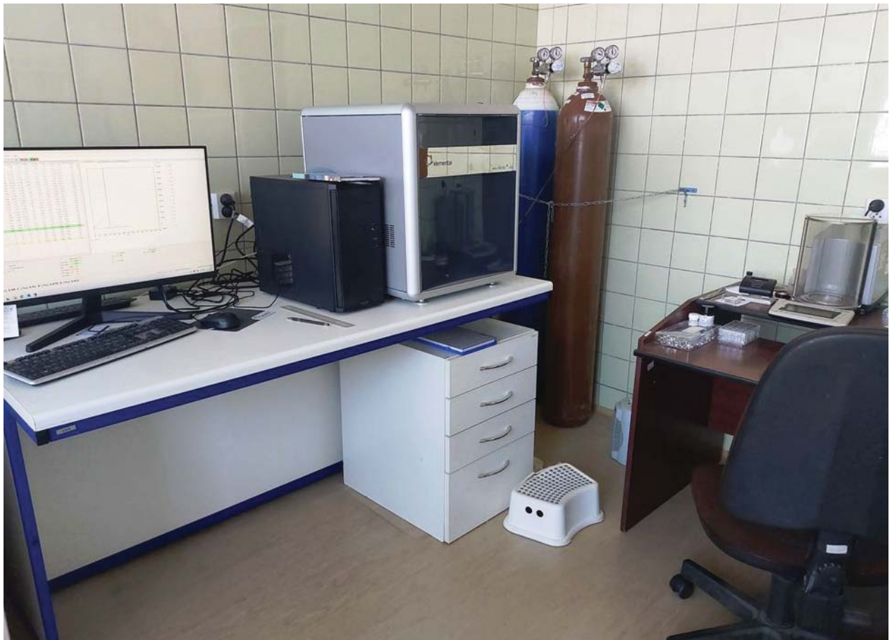
Elementárny analyzátor prvkov CHNS vario MACRO cube na stanovenie obsahu uhlíka, vodíka, dusíka a síry pomocou vysokoteplotného spaľovania vzorky v prúde kyslíka (nosný plyn – argón)
