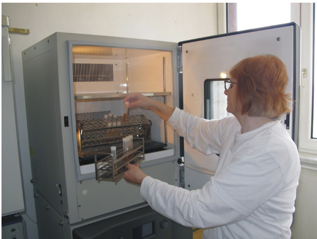
Mikrobiálne kultúry sa kultivujú za miešania v termostatických trepačkách.
