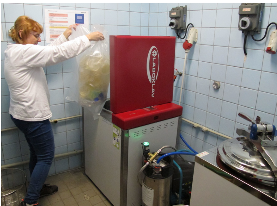
Po ukončení mikrobiologických experimentov sa vzorky dekontaminujú v autokláve.
