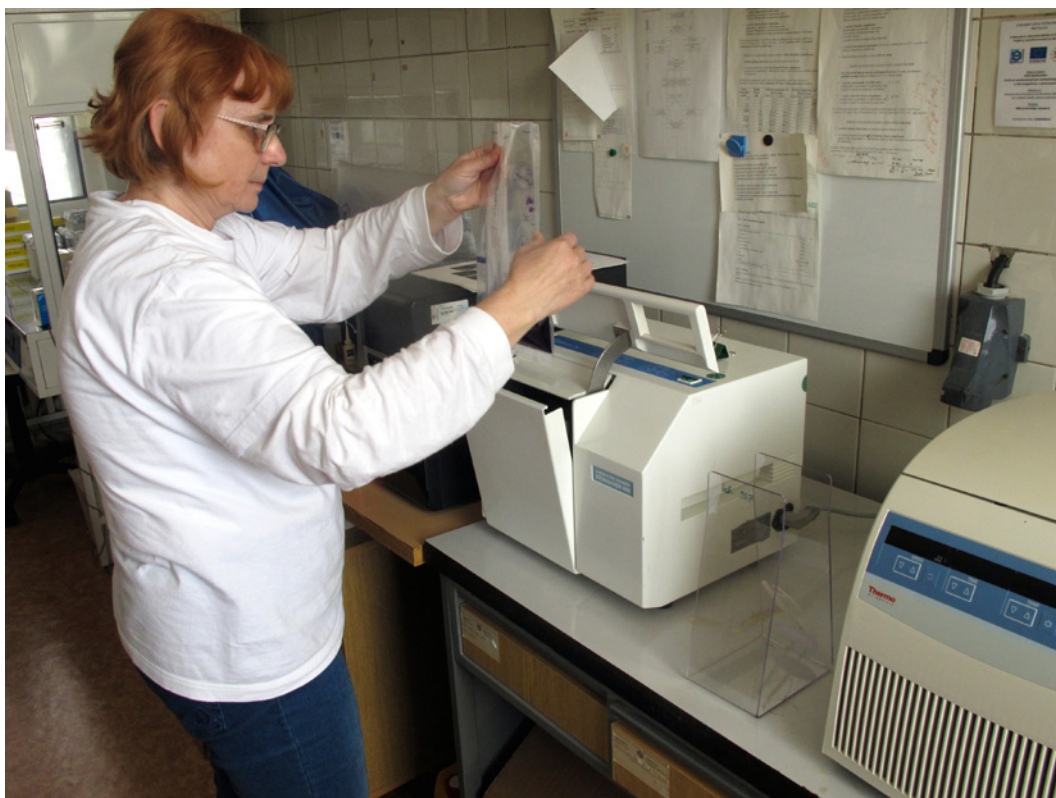
Vzorky potravín sa v médiách suspendujú v pedálovom homogenizátore typu stomacher.
