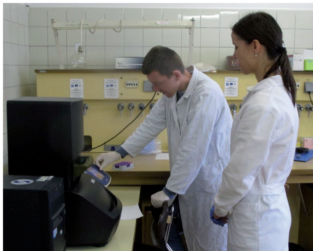
Na analýzu mikrobiómu potravín sa používa polymerázová reťazová reakcia, ktorá sa realizuje v programovateľnom termocykléri.
