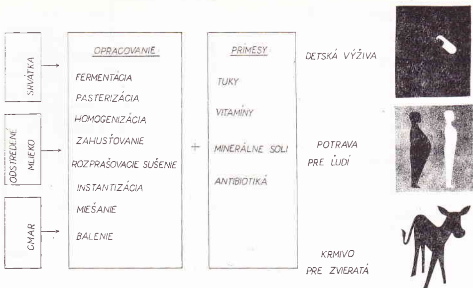
Obr. 26. Spracovanie odpadov mliekárskoho priemyslu sušením.
